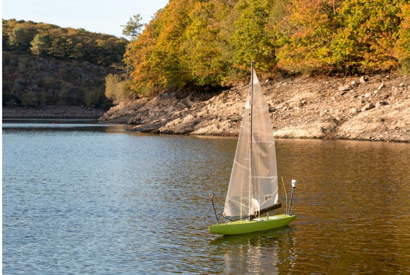
Figure 1: Brave navigant de façon autonome sur le Lac de Guerlédan.
