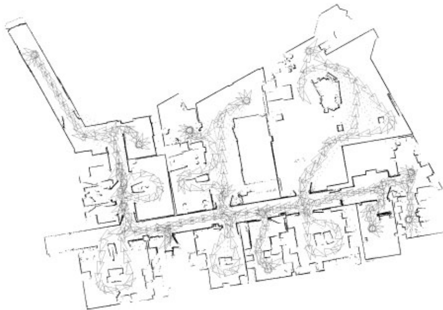
Exemple de carte créée par une méthode de SLAM utilisant un télémètre laser en intérieur.
