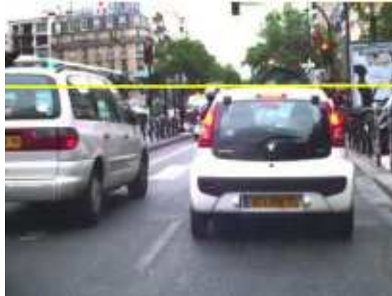
FIGURE 3 – Restriction sur la recherche des feux : la région en-dessous de la ligne peut être exclue sans danger de perdre des détections potentielles. Une telle restriction réduit aussi le danger des fausses détections : comme on peut le constater, les feux arrières de la voiture blanche sont exclus, faute de quoi ils auraient sûrement été considérés comme feux de circulation.
