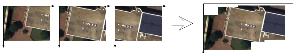
FIGURE 8 – Exemple de Mosaïque d'images. Le SLAM permet de calculer la position relative des images avant de les fusionner dans une image commune.
