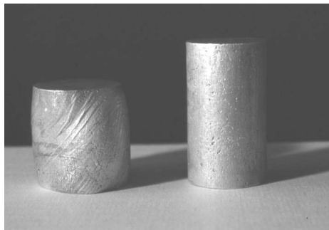
Compression sur monocristal d'Aluminium
