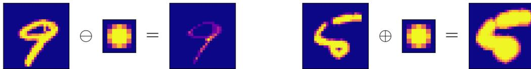
Exemple d'une opération d'érosion  $\ominus$  et de dilatation  $\oplus$  d'une image MNIST par un élément structurant circulaire.
