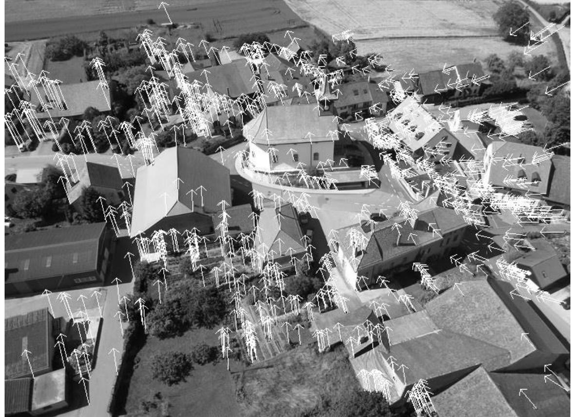
*Flot optique LK pyramidal (OpenCV)*
