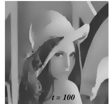
*Diffusion anisotrope, schéma de décroissance hyperbolique (Image sur 8 bits,  $K=15$ ).*
