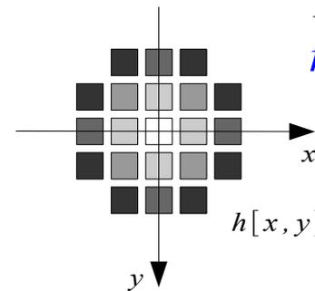
Les nouvelles valeurs du pixel sont calculées par *produit scalaire* entre le noyau de convolution et le *voisinage* correspondant du pixel.
