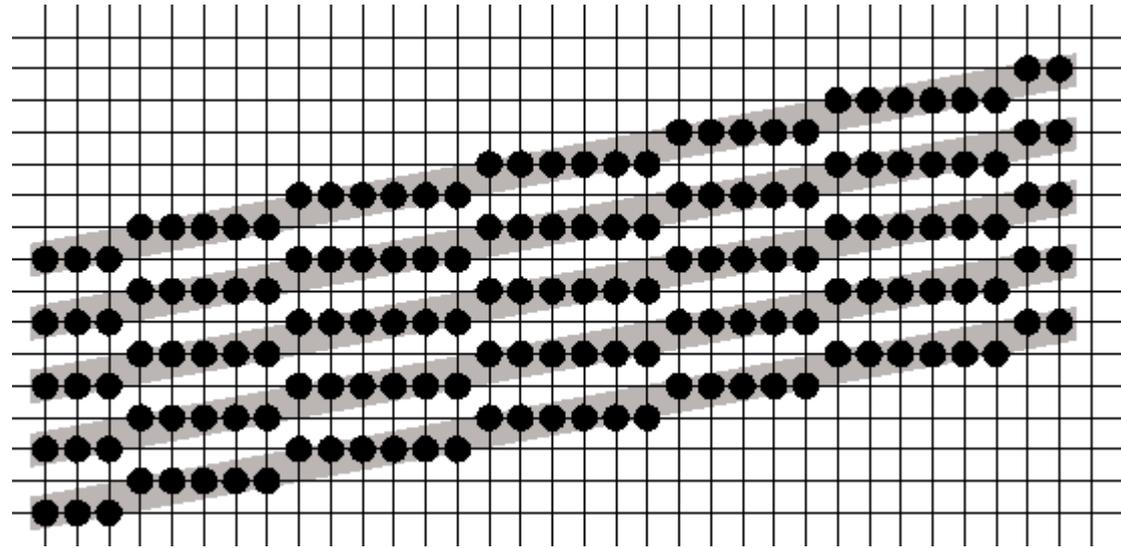
Mais en considérant seulement 1 échantillon sur 2, une structure différente apparaît, dont l'analyse (ici des bandes verticales, plus épaisses) ne sera pas conforme à la réalité de l'objet :
