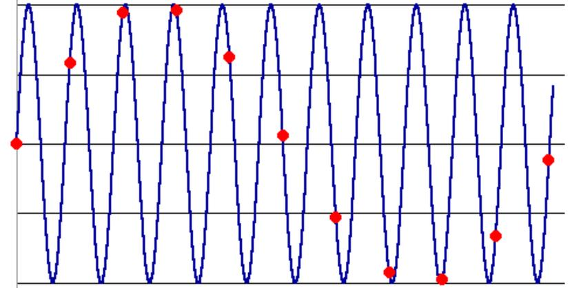
Ce phénomène appelé *aliasing* est encore pire en 2d, car il affecte *la fréquence et la direction* des structures périodiques. Imaginons par exemple qu'on souhaite échantillonner l'image correspondant aux bandes noires ci-contre :
