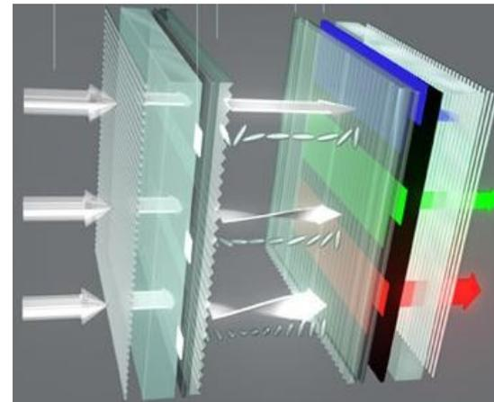
*Dans les écrans à cristaux liquides (LCD), 3 matrices de cristaux liquides sont contrôlées par un couple de polariseurs qui change l'orientation, des cristaux, en modifiant la transparence de chaque pixel, ces matrices sont rétro-éclairées à travers des filtres rouge, vert et bleu.*
