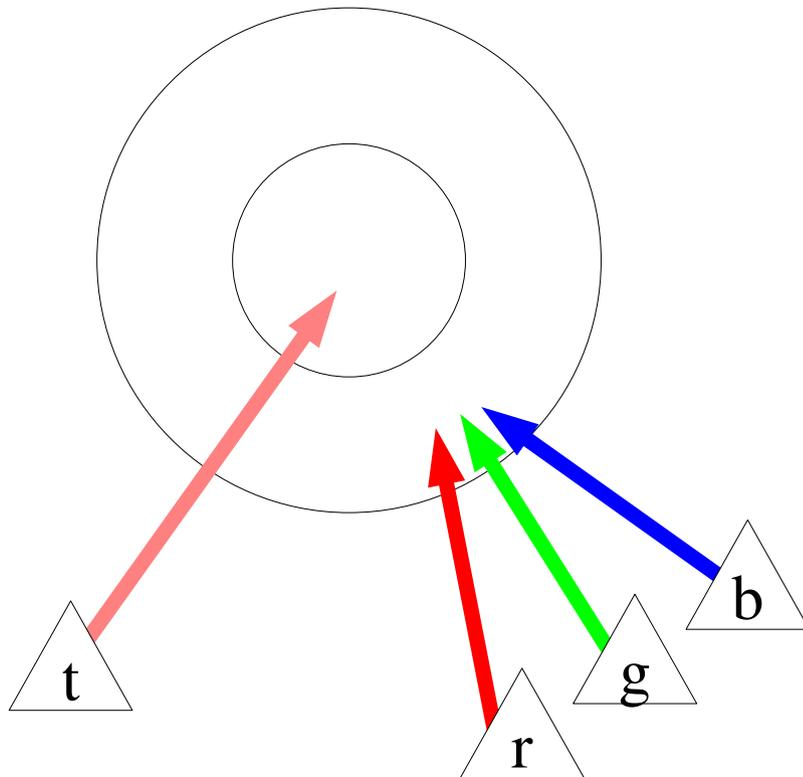
Expérience de « color matching » : une source lumineuse cohérente  $t$  est comparée à un mélange des 3 couleurs. On dose les taux  $(r,g,b)$  jusqu'à ce que les 2 zones soient perçues parfaitement identiques.
