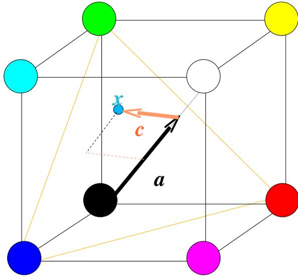
Un point  $x$  de coordonnées  $(r,g,b)$  du cube RGB peut être décomposé en deux composantes  $(c,a)$ . Soit  $y$  la projection orthogonale de  $x$  sur l'axe achromatique.
