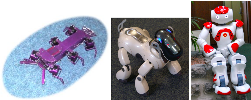
Figure 4.5: Exemples de robots à pattes. Hexapode de AAI Canada, Aibo de Sony, Nao de Aldebaran Robotics.
