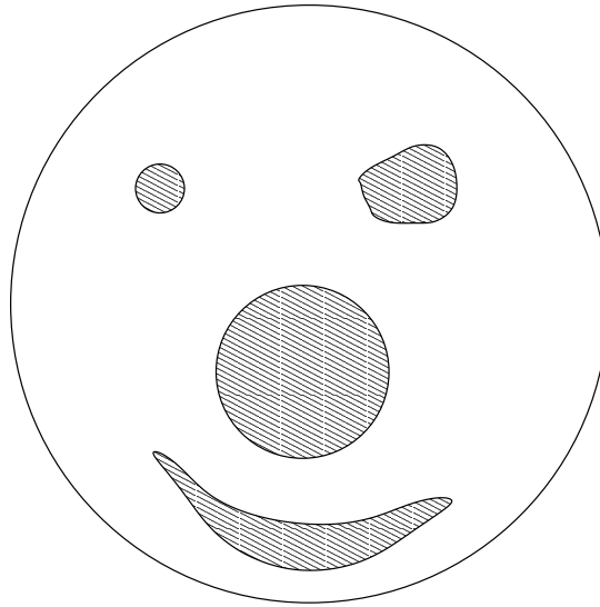
FIG. 1.3 – Modèle 3D : cavité avec quatre conducteurs internes ( I = 4 )
