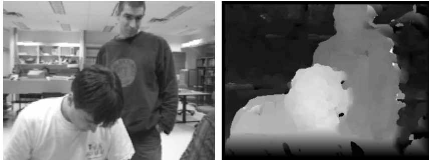
FIGURE 4.16 – Exemple de données fournies par des caméras stéréoscopiques.
