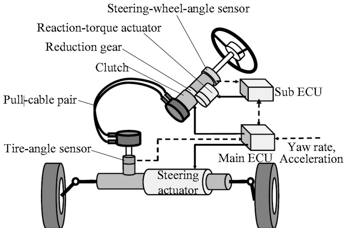
Le calculateur Sub ECU a pour but de piloter le moteur de retour de force.
