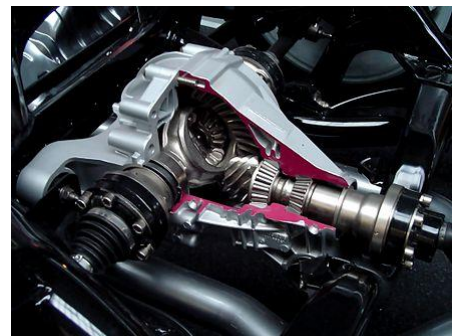
Figure 1: Différentiel Central de la Porsche Cayenne
