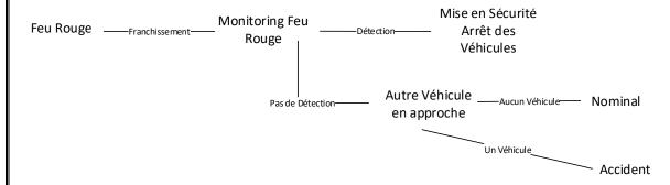
Pour passer à l'arbre de faute, il est nécessaire d'associer une probabilité à chacune des transitions possibles :
