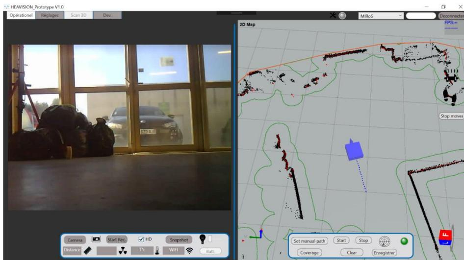
Figure 1 : IHM de pilotage (à gauche : retour caméra monoculaire).
