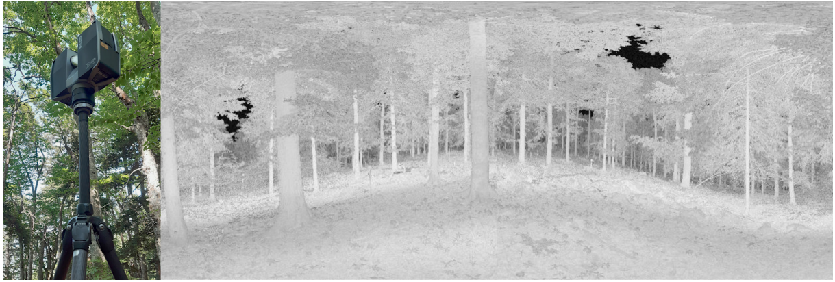
Photo d'un appareil de LIDAR terrestre en forêt et projection d'un scan 3D réalisé par LIDAR au Mont Ventoux. Résolution originale : 10142 x 4268 points. INRAE URFM
