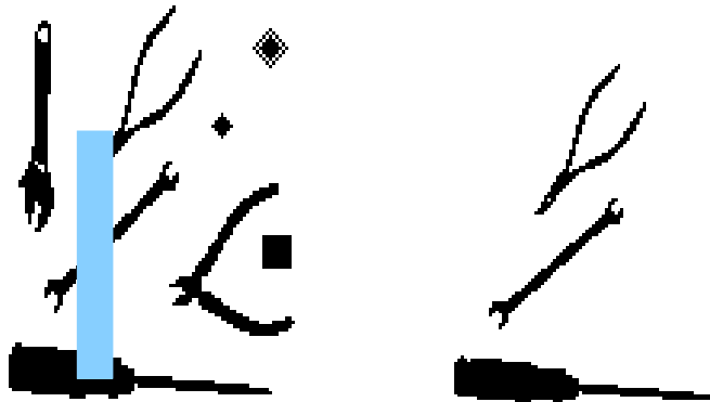
FIG. A.5 – La reconstruction géodésique est définie par l'ensemble des composantes connexes de l'image qui intersectent le marqueur matérialisé par le rectangle bleu.
