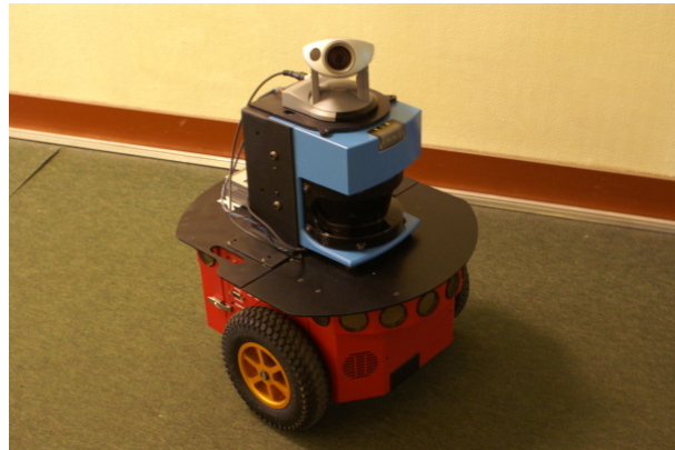
FIG. 3.6 : Robot Pioneer 3 DX utilisé pour les expériences en environnement réel équipé d'une caméra Canon VC-C50i et d'un télémètre laser (non utilisé dans nos expériences).
