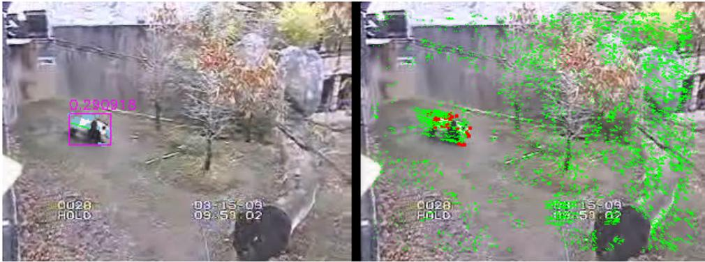
FIGURE 5.4 – Illustration du fonctionnement de la segmentation d'objets mobiles. À gauche, l'objet détecté comme mobile est marqué par sa boîte englobante rose. À droite, nous avons affiché l'ensemble des particules suivies dans la vidéo, en marquant en rouge les trajectoires se détachant du mouvement fond.
