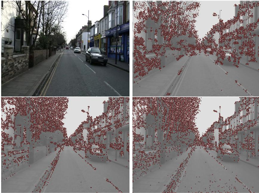
FIGURE 3.3 – De gauche à droite et de haut en bas : 1 - Image utilisée pour l'évaluation des détecteurs. 2 - Points extraits avec le détecteur idéal (les 10 000 points avec la plus petite erreur de suivi). 3 - 10 000 points d'intérêt FAST. 4 - 10 000 points d'intérêt MIEL.
