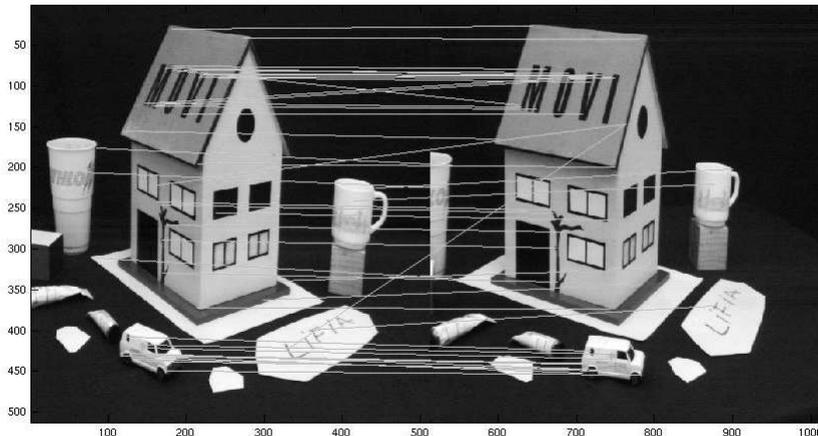
Résultat d'appariement par SIFT entre l'image (2) à gauche, 510 points détectés, et l'image (1) à droite, 589 points détectés. 51 points ont été appariés, ce qui correspond à une distance euclidienne entre les descripteurs en deçà d'un certain seuil.
