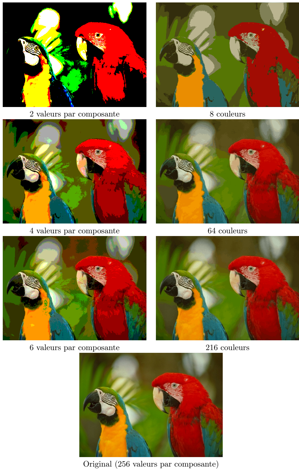
FIGURE 4.5 – Quantification des couleurs par K-Means (à droite), comparée à une quantification uniforme des composantes ( R, G, B ) (à gauche) pour le même nombre de couleurs.
