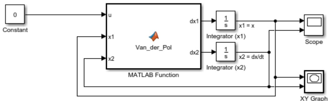
La fonction d'état est codée dans le bloc **MATLAB Function** :
