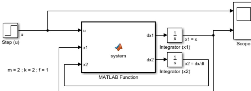
La fonction d'état est codée dans le bloc **MATLAB Function** :
