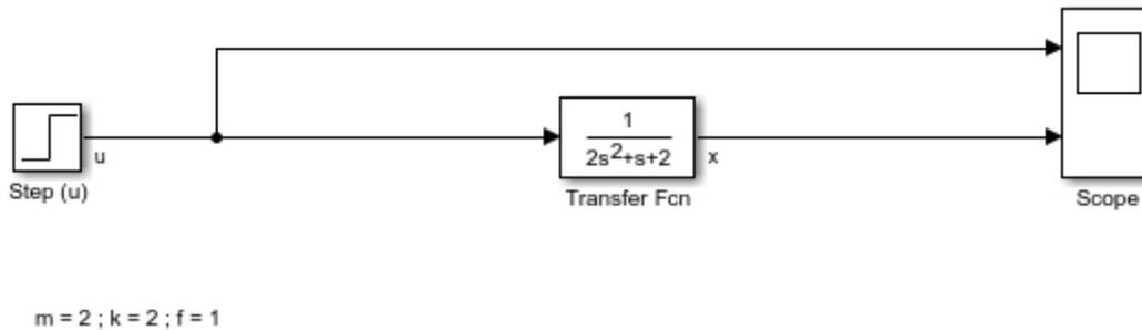
L'oscillateur amorti peut également être représenté sous forme d'état :
