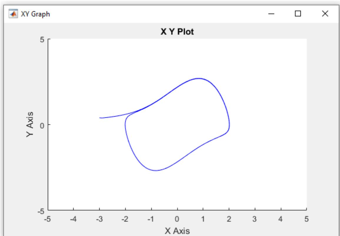
Quelles que soient les conditions initiales (hormis le point d'équilibre instable), l'état du système converge vers le cycle limite.
