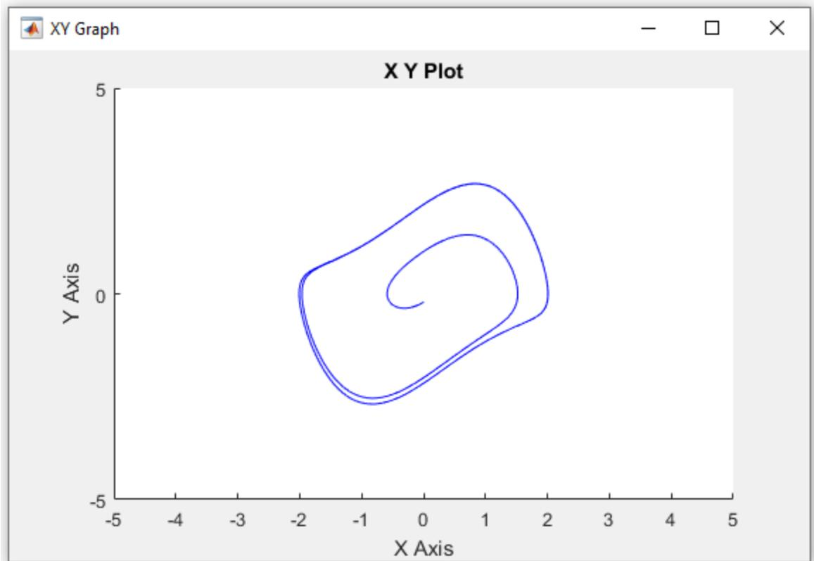
Avec  $x(0) = -3$  et  $\frac{d}{dt}x(0) = 0,4$  (conditions initiales à l'extérieur du cycle limite), on obtient le comportement suivant :
