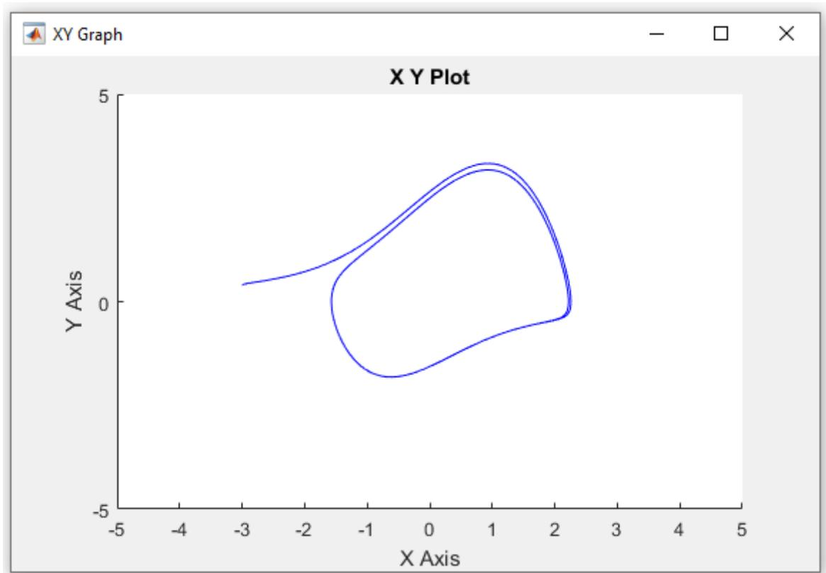
Avec  $u(t) = 1$ , le système semble converger de plus en plus lentement vers un point d'équilibre.
