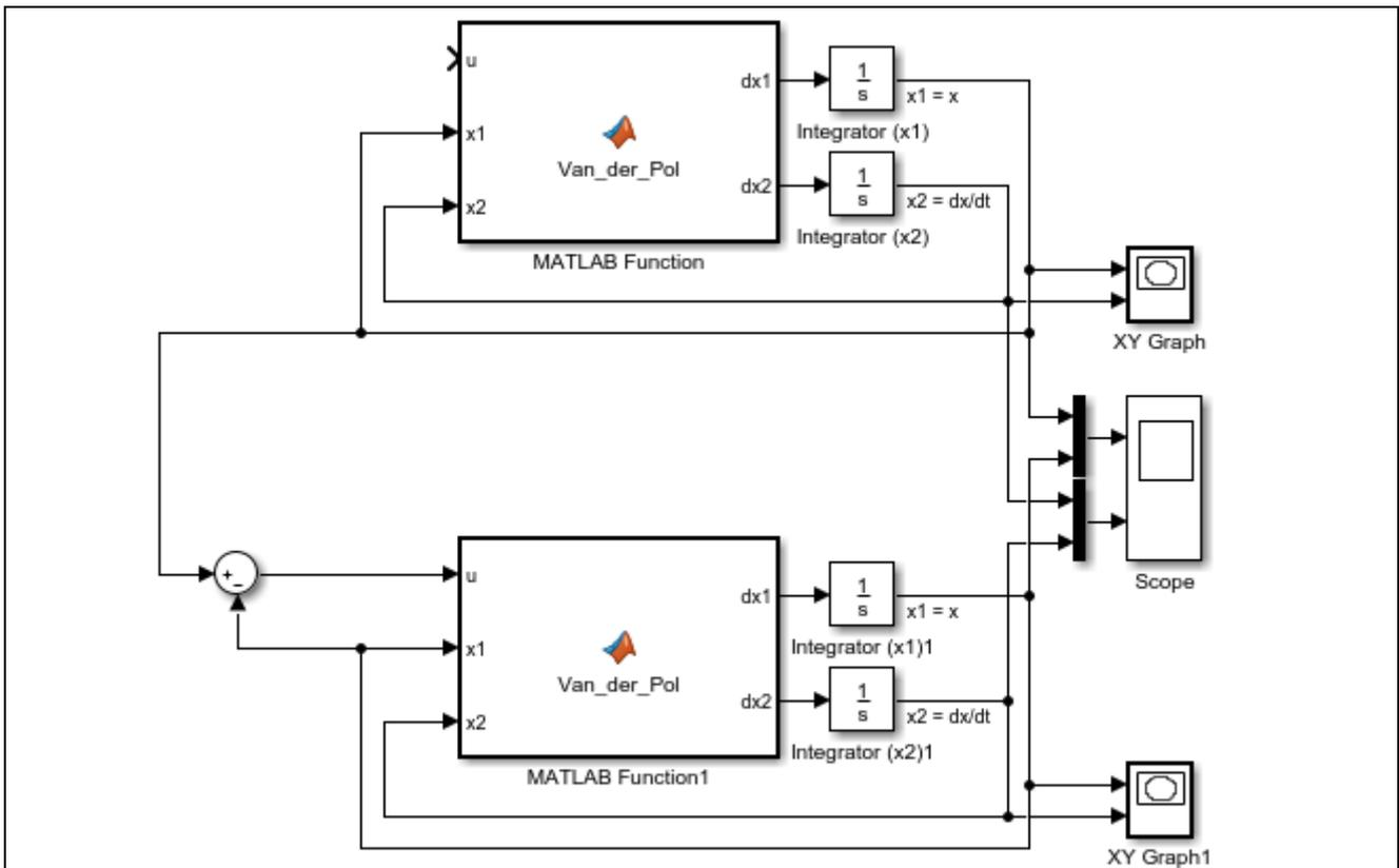
On choisit d'initialiser le second oscillateur de Van der Pol sur la position d'équilibre instable  $x = \frac{d}{dt}x = 0$ .
