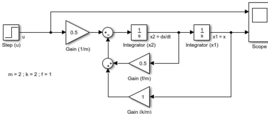
Le bloc **Step** permet de générer une consigne  $u(t)$  en échelon. Le bloc **Scope** permet de visualiser l'évolution de variables d'intérêt.
