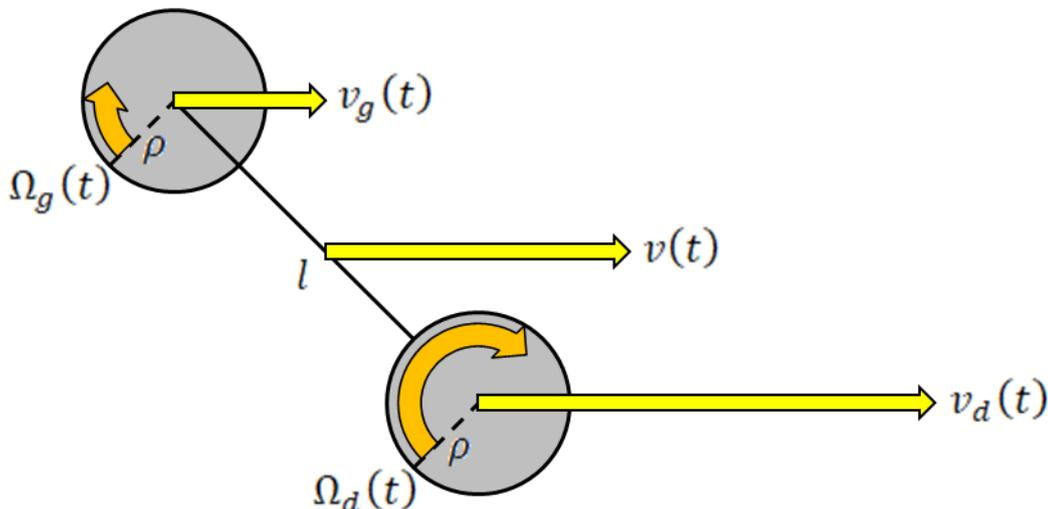
$v_d(t)$  et  $v_g(t)$  les vitesses de déplacement des roues au niveau des essieux droit et gauche sont données par transport de la vitesse du milieu de l'essieu :
